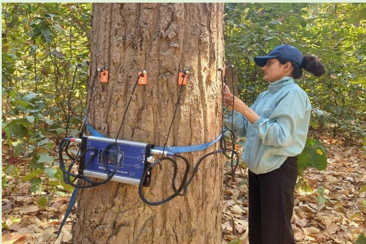
तस्वीर: टोमोग्राफ मेसिन सालको रुखमा जडान गरी इलेक्ट्रोनिक ह्याम्मरको सहायताले sonic data लिदै केन्द्रका इन्टर्न विद्यार्थी
